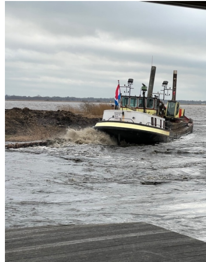
Door werking van schroef wordt slib opgewoeld
