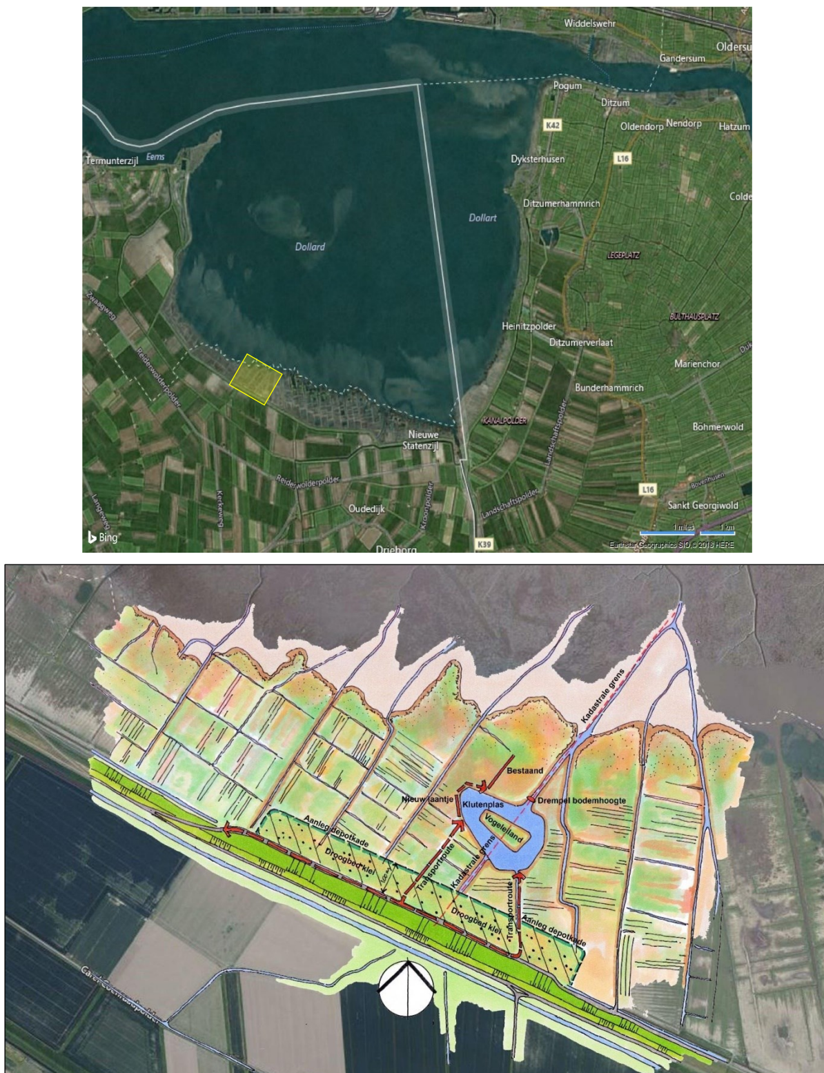
Figuur 1.1 Het demonstratieproject BGD: (A) globale ligging in de zuidelijke Dollard en (B) overzicht van de inrichtingsmaatregelen en activiteiten in het demonstratieproject BGD (naar Riemersma 2018).
