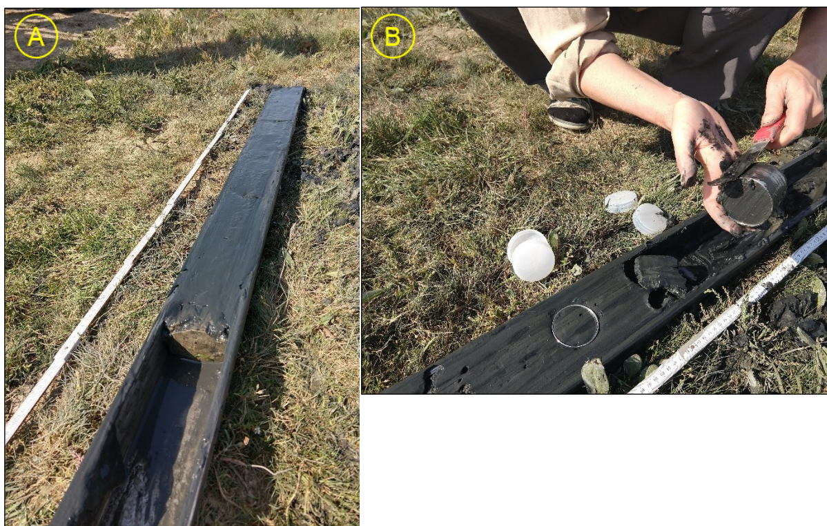
Figuur 3.1 (A) Vrijwitboor met ongestoorde boorkern van 115 centimeter uit de Klutenplas na het verwijderen van de afsluitende schuif. (B) het nemen van deelmonsters met behulp van RVS-steekringen.
